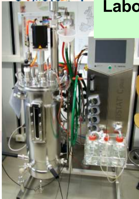
Unità di fermentazione vol. 30 litri
